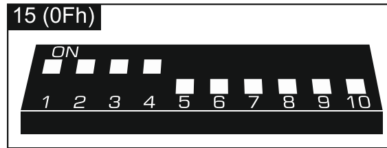
3. Ábra INT-O bővítő DIP kapcsolóinak beállítása.
